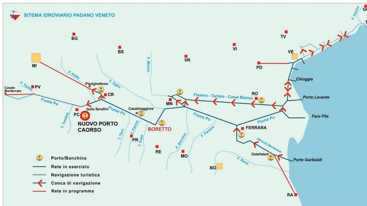
Figura 16 – Sistema Idroviario Padano Veneto con inquadramento del nuovo porto fluviale
